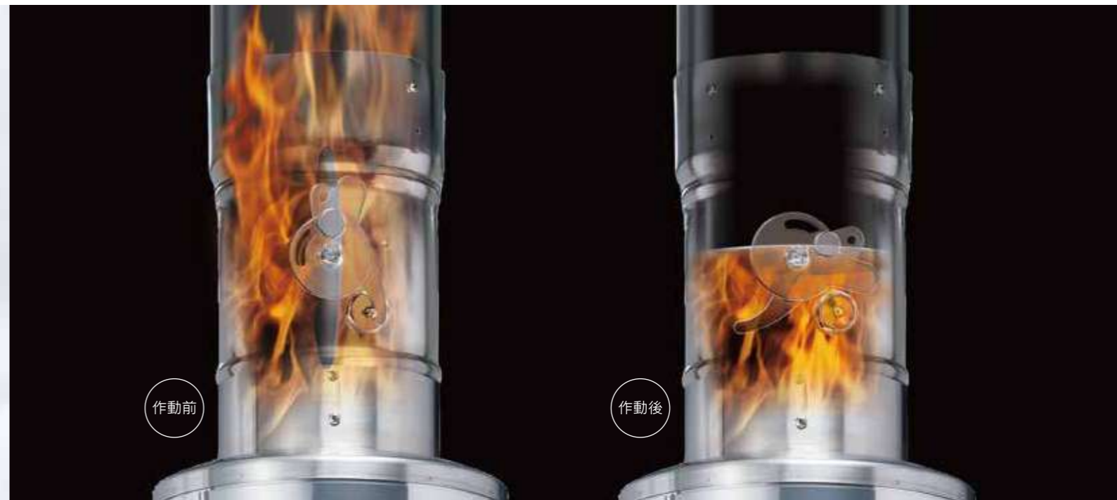
防火ポリウレタンダンパー作動の概念図(図-②)
